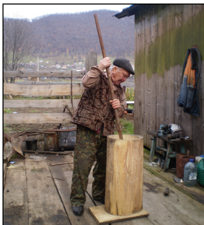
Рис. 4. Процесс изготовления долбленной посуды со вставным дном. За работой Г.Г. Шагисултанов. Республика Башкортостан, Белорецкий р-н, с. Зуяково. 2011 г. Фото автора.
